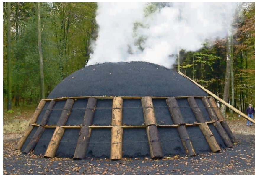
Während rund 10 Tagen stieg zuerst weisser, gegen Ende dann bläulicher Rauch aus den vom Köhler gestochenen Rauchlöchern.
